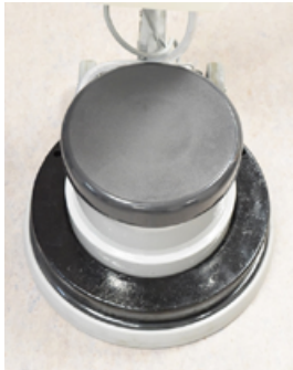
Abb. 8 8: Maschinenkopf mit montierten Gewichten
