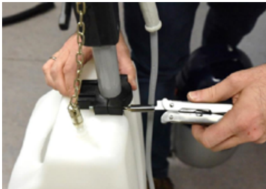
Abb. 8 72: Befestigen des Tanks an der oberen Halterung
